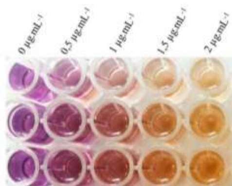
Figura 2. Microplaca com a reação da curva padrão para ácido gálico ( 0 - 2 \mu\text{g.mL}^{-1} ). Note que a perda da cor violeta representa menor absorbância e, portanto, maior redução do radical DPPH. Para cada ponto da curva de ácido gálico são apresentadas três repetições.
